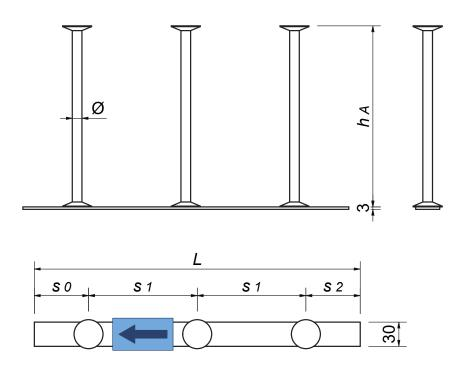
Doppelkopfanker-Leiste mit Ankerabstäden und Etikettierung (Pfeil auf Etikette zeigt in Richtung des Auflagers/Stütze)
