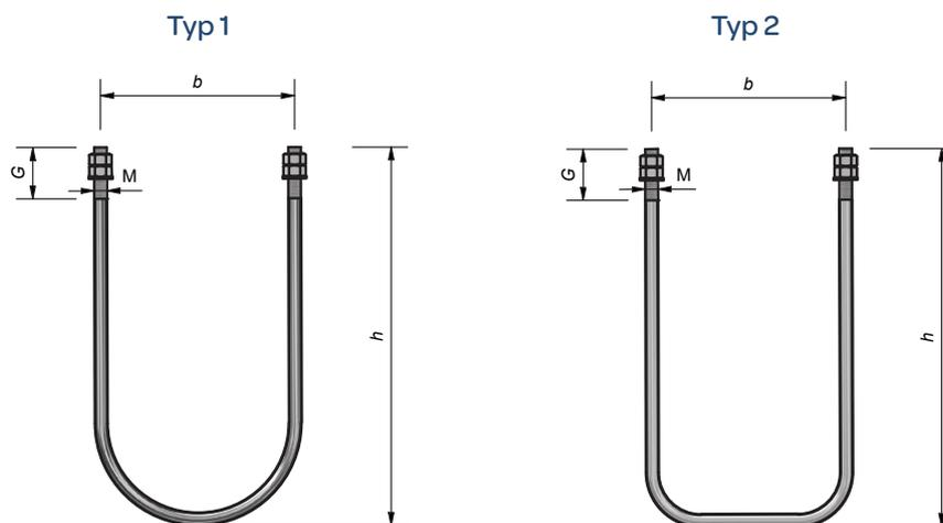
Folgende minimale Abmessungen sollten nicht unterschritten werden. Bitte nehmen Sie frühzeitig mit GRAVIS Kontakt auf, falls diese Minimalabmessungen nicht eingehalten werden können.
